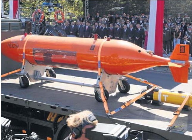
Kongsberg Hugin 1000 MR, autonomiczny pojazd podwodny do poszukiwania obiektów na dnie morskim
