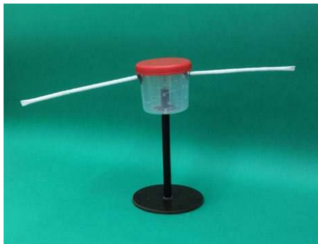
Fot. 1. Wygląd zewnętrzny jednego ze budowanych modeli silnika odrzutowego, w którym wykorzystano pojemnik dostępny w aptekach.
