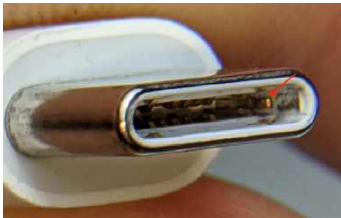
Fotografia 5. Miniaturowy zatrzask wewnątrz wtyku USB-C ( https://t.ly/3IBMx )
