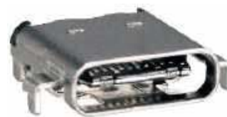
Fotografia 9. Gniazdo USB-C typu mid-mount ( https://t.ly/l92X7 )
