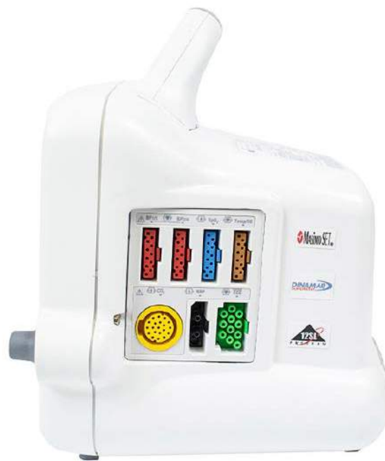
Fotografia 1. Panel gniazd sygnałowych w kardiemonitorze GE Dash 3000. Uwagę zwraca zróżnicowanie kształtów, kolorów korpusów izolacyjnych oraz ułożenia kluczy kodujących orientację złączy ( https://t.ly/DvPo )
