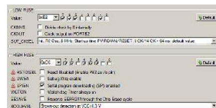
Rysunek 3. Szczegóły ustawienia bitów zabezpieczających
