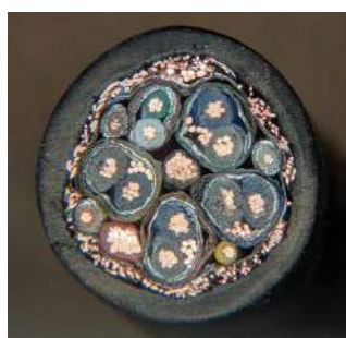
Fotografia 8. Przekrój kabla USB C z czterema parami przewodów typu twinax zamiast ośmiu osobnych przewodów koncentrycznych ( https://t.ly/BNT2 )
