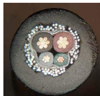
Fotografia 9. Przekrój typowego kabla USB 2.0 ( https://t.ly/YBIJ )
