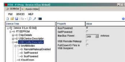
Rysunek 4. Konfiguracja układu FT230 – ustawienie prądu USB
