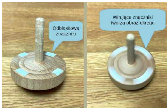
Fotografia 1. Bączek z przyklejonym reflektorem. Gdy się obraca, reflektory zlewają się w okrąg
