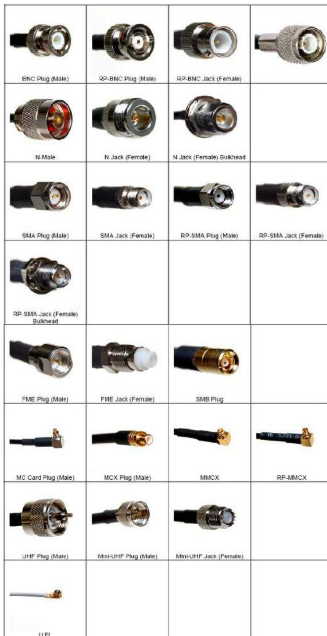
Fotografia 23. Typowe wtyki koncentryczne. Oznaczenie RP wskazuje odwrótną konstrukcję mechaniczną (np. wtyk żeński zamiast standardowego męskiego) ( https://t.ly/0d_W , https://t.ly/8MdQ )
