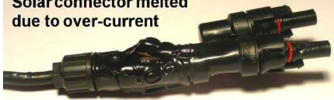
Fotografia 3. Przykład uszkodzenia termicznego izolacji złącza fotowoltaicznego, spowodowanego przekroczeniem prądu maksymalnego ( https://t.ly/9dyF )
