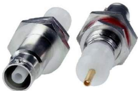
Fotografia 2. 10-kilowoltowe złącza jednobiegunowe typu HC51 – widoczne izolatory teflonowe (białe elementy) separują środkowy pin złącza od metalowego korpusu na całej długości elementu, co znacząco zwiększa odstęp powierzchniowy ( https://t.ly/mWOi )
