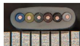
Fotografia 14. Przekrój płaskiego kabla telefonicznego ( https://t.ly/Oewd )
