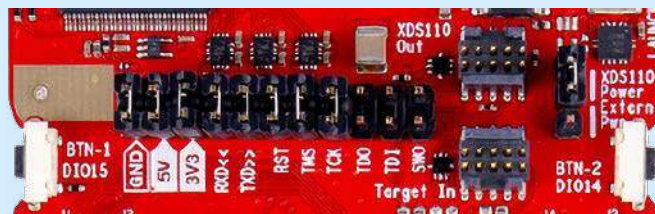
Rysunek 8. Złącze P4 zestawu CC1352R1 LaunchPad
