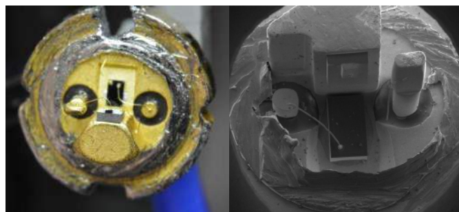
Fotografia 2. Zdjęcie mikroskopowe diody laserowej małej mocy
