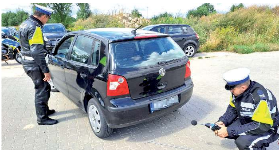
Badanie sonometrem jest bardzo proste i szybkie. Wystarczy, że samochód poddawany kontroli znajdzie się na utwardzonej nawierzchni i policjant zbliży mikrofon urządzenia w pobliże rury wydechowej
