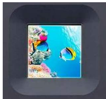
Fotografia 19. Wygląd prototypowego wyświetlacza Micro-Led (za JDI)
