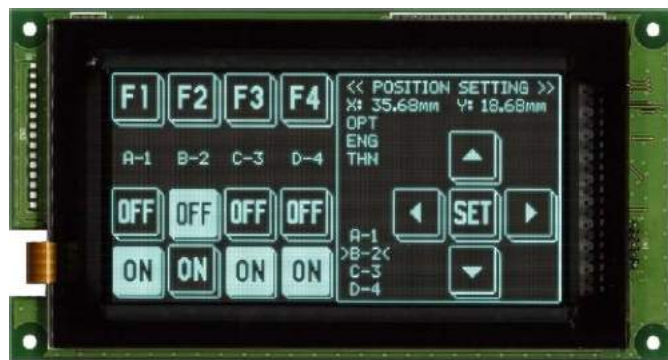
Fotografia 21. Wyświetlacz graficzny VFD GU256x128D-D903M (z materiałów Noritake-Itron)
