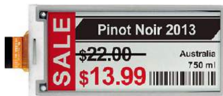
Fotografia 10. Wyświetlacz EA2220-BJA z pigmentem czerwonym (za notą Eink)
