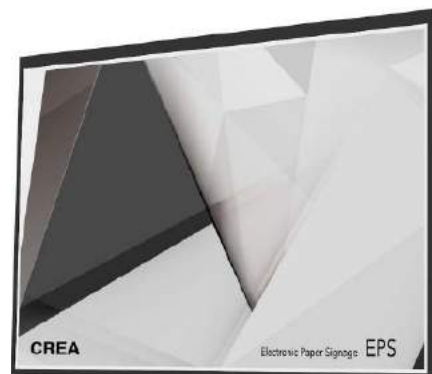
Fotografia 14. Panel Crea EPD typu EPS2-C07 (za notą Eink)
