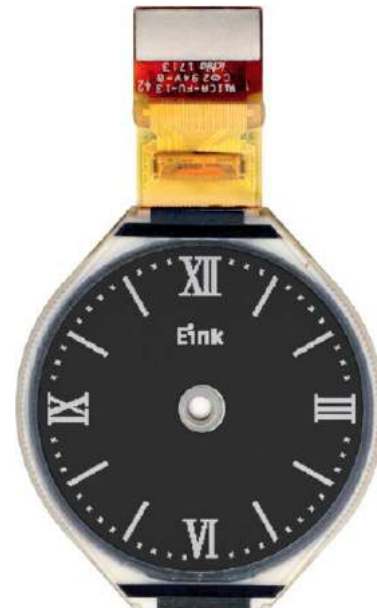
Fotografia 9. Wyświetlacz o okrągłym polu odczytowym ET011TJ2 (za notą E Ink)
