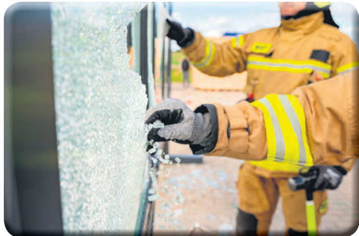
Szkło hartowane rozpada się na drobne, bezpieczniejsze, tępe odłamki. To ważne przede wszystkim przy dużych przeszkleniach.
