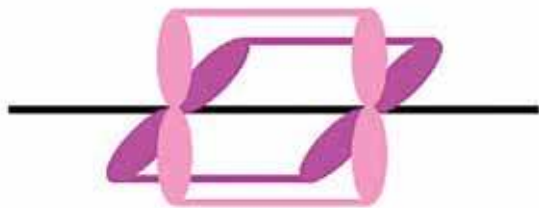
Rys. 18. Schematyczny obraz tworzenia jednego wiązania \sigma i dwóch podwójnych wiązań \pi w karbinie.
