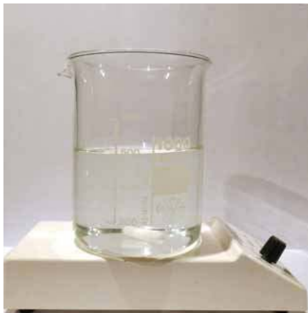
Fot. 5 – Naczynie z mieszaniną reakcyjną umieszczone na mieszadle magnetycznym
