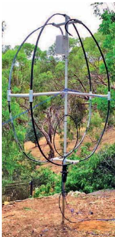
Antena magnetyczna na pasmo 160 m („QST” 4/19)
