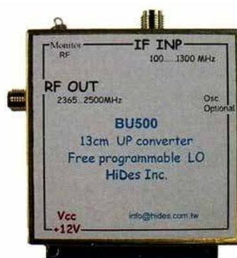
Fot. 13. Tajwański transwerter BU500 ma programowaną heterodynę
