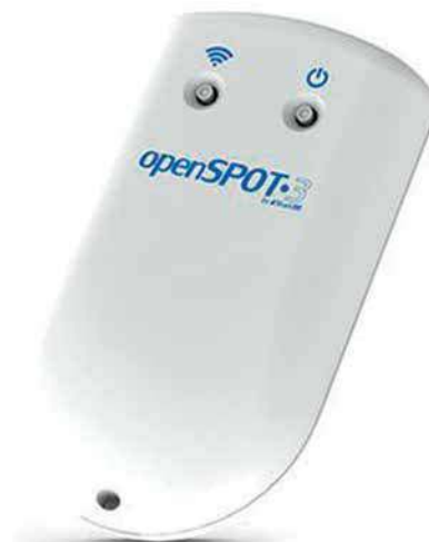
Fot. 2. Mikroprzemiennik OpenSpot-3 pozwala na korzystanie z systemów P25, NXDN i DMR za pośrednictwem radiostacji C4FM i z systemu C4FM za pośrednictwem radiostacji P25. Oprócz rozszerzonych możliwości pracy skrośnej – w sumie do dyspozycji jest 14 kombinacji z pięciu systemów – różni się od OpenSpota-2 wbudowanym akumulatorem 1,2 Ah, którego pojemność wystarcza na 10 godzin autonomicznej pracy
