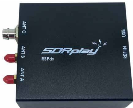
Fot. 8. Programowalne odbiorniki w rodzaju RSP firmy SDRplay dobrze spisują się przy odbiorze satelity
