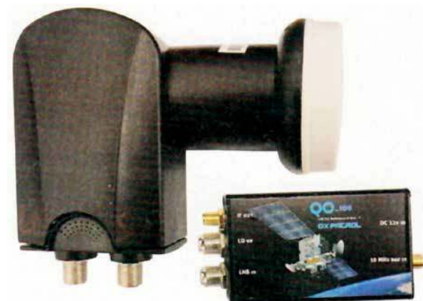
Fot. 7. Zestaw odbiorczy firmy DX-Patrol składa się ze zmodyfikowanego konwertera LNB i generatora częstotliwości wzorcowej
