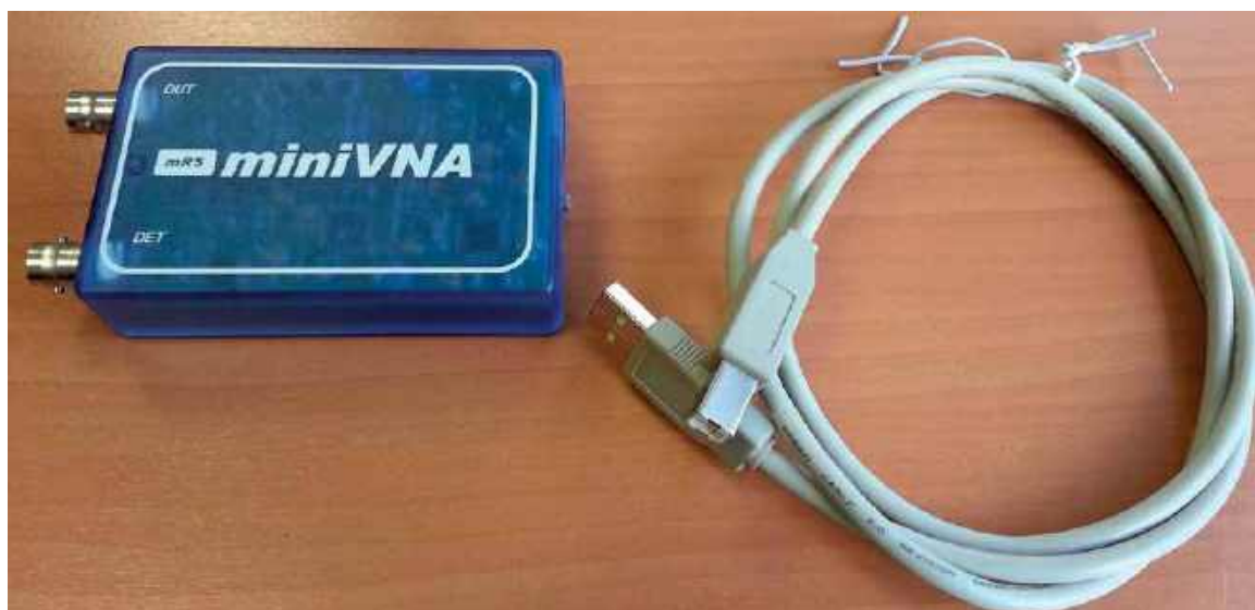
Rys. 8. Analizator anten miniVNA
