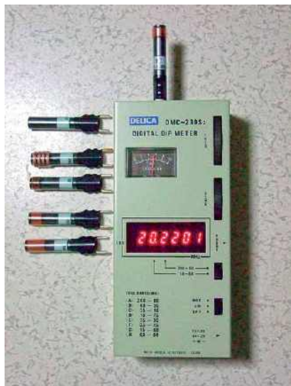
Rys. 3. Nowoczesny TDO z cyfrowym częstotściomierzem
