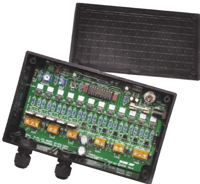
Fotografia 3. Płytkę PCB montuje się w obudowie bez użycia śrub – po prostu wsuwa się ją w szczeliny na bocznych prowadnicach. Póki co, w pokrywie nie wywiercono otworów na włącznik/wyłącznik i diodę LED – można to zrobić używając przedniego panelu jako szablonu
