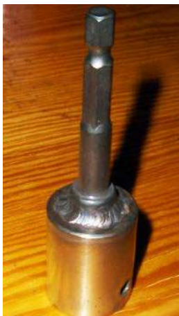
Rysunek 11. Redukcja z kwadratu 3/8 cala na sześciokąt służąca do napędzania wrzeciona nawijarki wkrętarką akumulatorową zespawana z adapterem „na sztywno”
