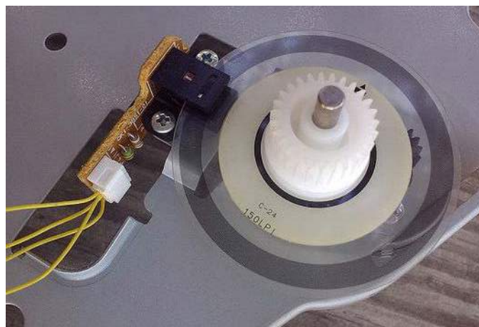
Fotografia 14. Zespół precyzyjnego enkodera inkrementalnego drukarki, złożony z modułu transoptora szczelinowego oraz tworzywowej tarczy z naniesionymi znacznikami optycznymi ( https://t.ly/CF6v )
