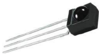
Fotografia 10. Odbiornik podczerwieni TSSP4P38 ( https://t.ly/C_fqF )
