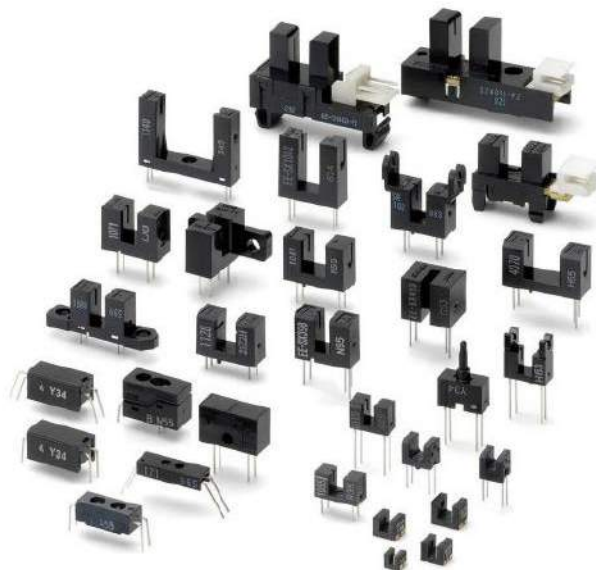
Fotografia 10. Różne modele transoptorów odbiciowych i szczelinowych ( https://t.ly/jrzW )
