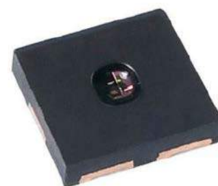
Fotografia 5. Sensor ALS typu VEML6031X00 Vishay ( https://t.ly/Jt5Lq )
