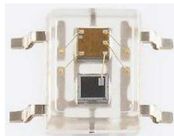
Fotografia 2. Konwerter światło-częstotliwości S9705-01DT marki Hamamatsu ( https://t.ly/Dm2A )
