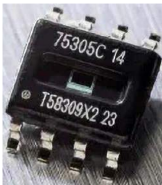
Fotografia 1. Czujnik MLX75305 marki Melexis ( https://t.ly/D2AS )
