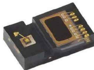
Fotografia 8. Czujnik odległości VCNL36825T marki Vishay ( https://t.ly/zo90L )
