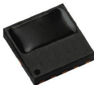
Fotografia 12. Miniaturowy odbiornik podczerwieni TSSP57P38 do montażu SMD ( https://t.ly/Gut4 )
