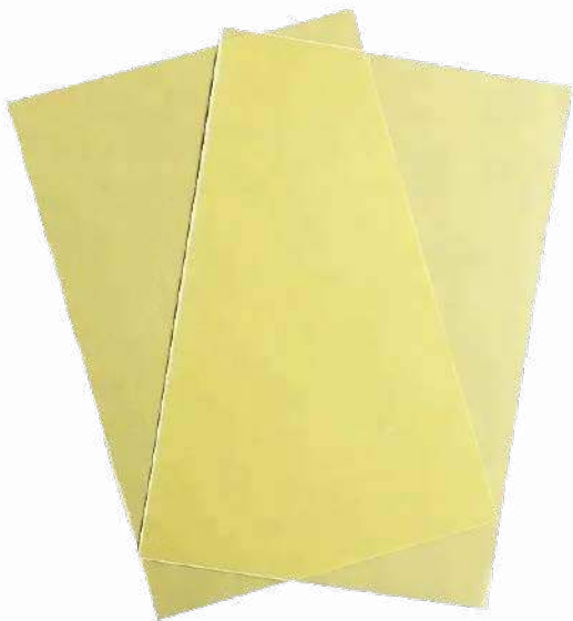
Fotografia 2. Surowe prepregi przed procesem laminacji PCB
