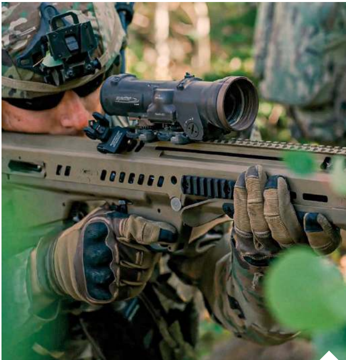
General Dynamics swój karabinek maszynowy NGSW-R zaprezentowało na targach Shot Show 2020. Broń została stworzona w układzie bezkolbowym, komorę zamkową umieszczono za mechanizmem spustowym | fot. YouTube/d
