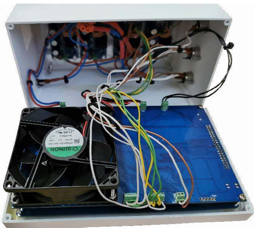
Fotografia 2. Zmontowany układ głównej płytki PCB oraz przetwornic
