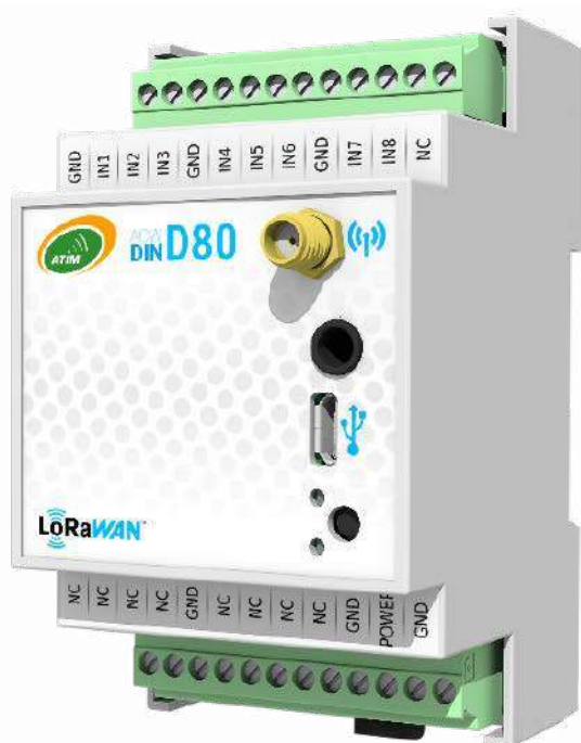
Fotografia 3. Kompaktowy moduł radiowy ACW-DIND80-G zgodny z wymogami przemysłowego internetu rzeczy IIoT
