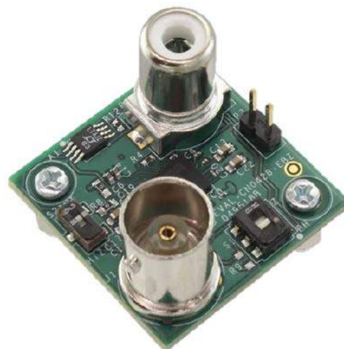
Fotografia 1. Płytka pomiarowa pH ADuCM355 ze złączami BNC i RCA
