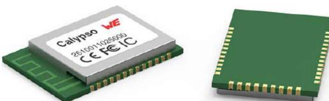
Rysunek 10. Moduł Wi-Fi typu Calypso z chipsetem serii TI-CC3220SF, który działa w standardzie IEEE 802.11 b/g/n w zakresie 2,4 GHz
