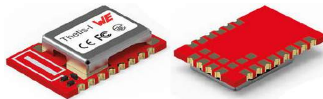
Rysunek 14. Moduł Thetis – I, który bazuje na protokole Wirepas i jest przeznaczony do budowy rozległych i energooszczędnych sieci IoT
