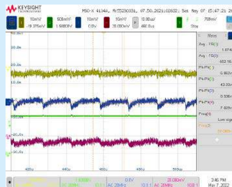
Rysunek 9. Praca układu TPS61094 podczas ładowania superkondensatora (Buck_on)
