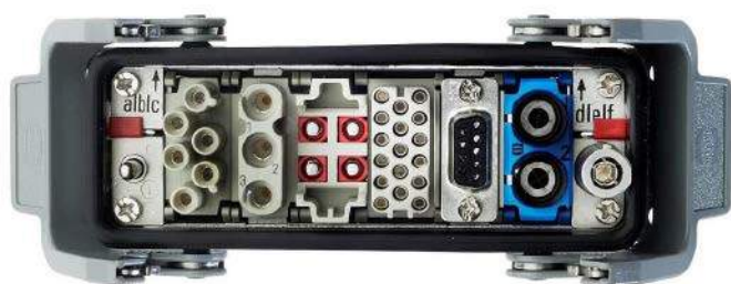
Fotografia 11. Kolejny przykład konfiguracji Han-Modular: kilka sekcji zasilających, jedna sygnałowa rastrowa, D-SUB 9 oraz jedna pneumatyczna dwutorowa (korpus w kolorze niebieskim, po prawej stronie) – https://t.ly/INS6
