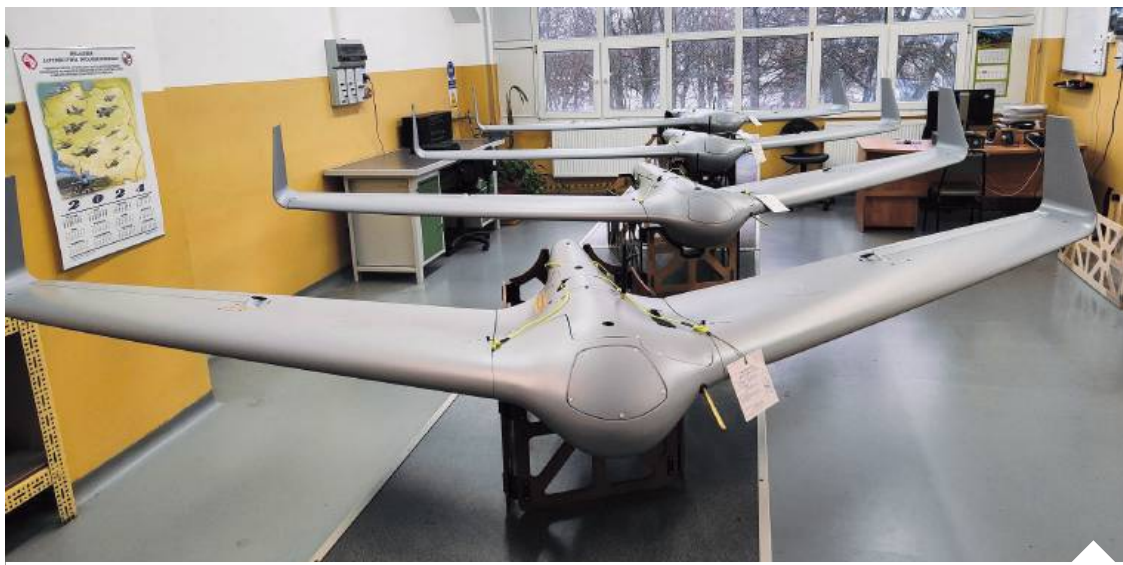
Wizjer to niewielki dron rozpoznawczy o zasięgu 30 km | fot. WZL/d
