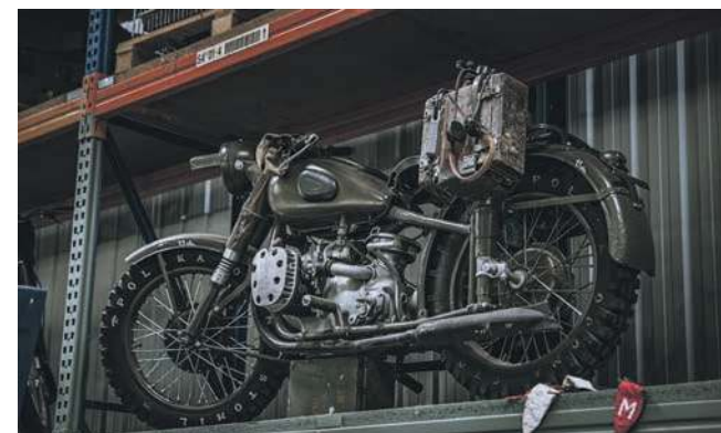
Motocykl radzieckiej produkcji M-72. Najczęściej spotykany w zestawie z wózkiem bocznym – w tej wersji radiostacja
