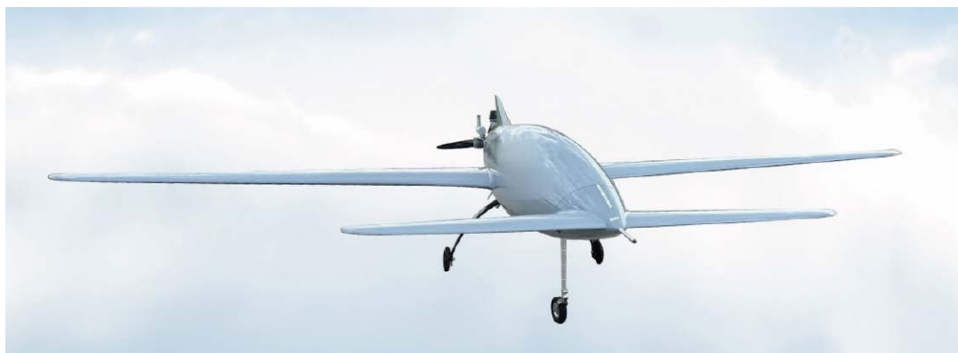
Ukraiński Bober (Uj-26). Charakterystyczny układ canard (kaczki): małe skrzydełka stabilizacyjne z przodu, duże skrzydła główne z tyłu. Kadłub z włókna węglowego, silnik spalinowy z tyłu. Długość ok. 2,5 m, rozpiętość 2,5 m. Źródło: https://cyclowiki.org/wiki/%D0%A4%D0%B0%D0%B9%D0%BB:UJ-26_Beaver.jpg
