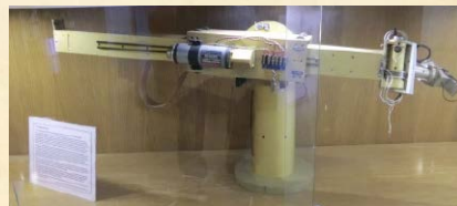
7. Stanford Arm – pierwsze w pełni elektryczne ramię robotyczne (1969) (Gildardo Sánchez – https://www.flickr.com/photos/gildardo/6186967797/ , CC BY 2.0, https://commons.wikimedia.org/w/index.php?curid=87699571 )
