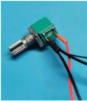
Fotografia 5. Podłączenie przewodów do potencjometru/przełącznika
