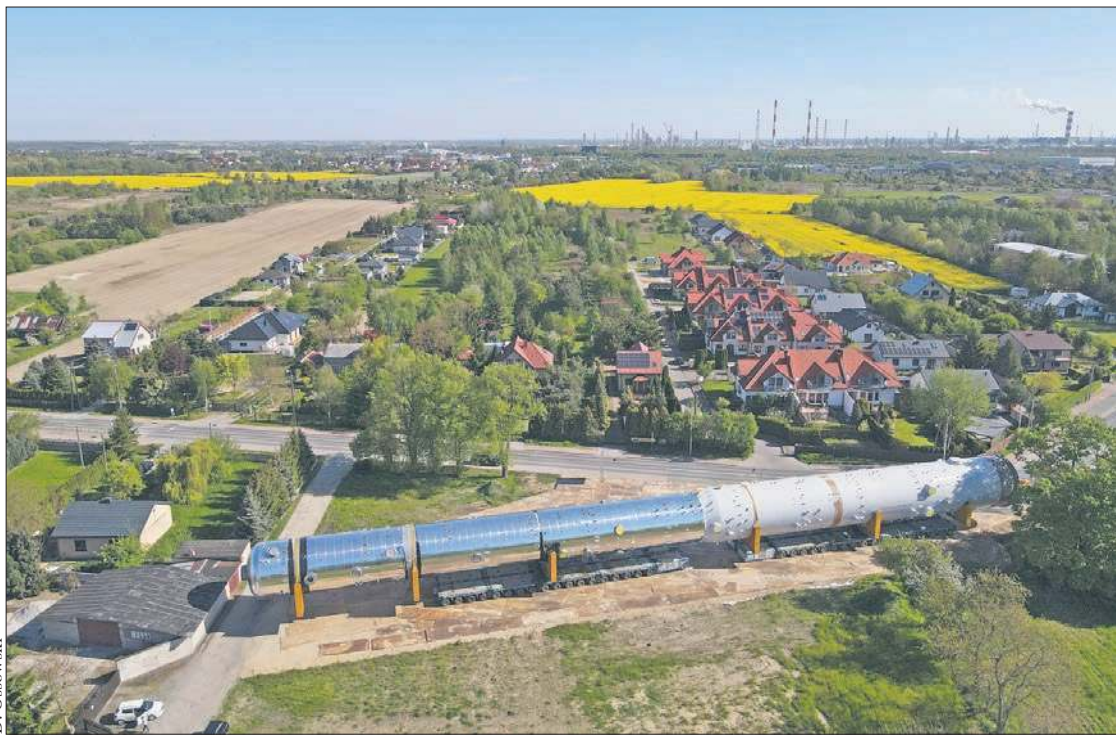
Do przewozu kolumny petrochemicznej wykorzystano 72-osiowy zestaw SPMT - liczący 576 skrętnych kół
