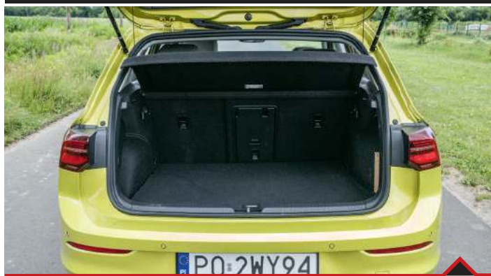
Bagażnik ograniczony przez znajdującą się pod nim baterię
