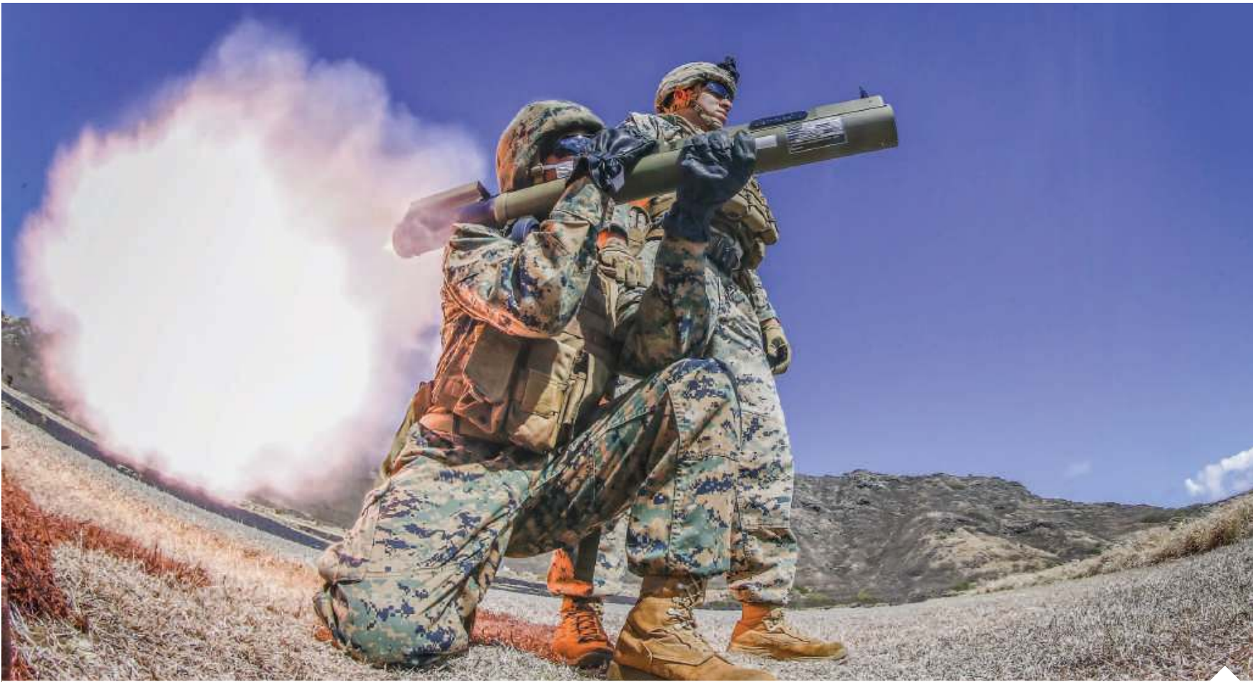
Granatnik M72 EC MK1 został wykonany m.in. z włókna węglowego i ma nową głowicę kumulacyjną | fot. USMC/Sgt. Luke Kuennen/d
