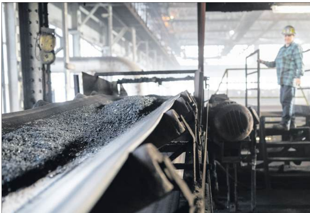
■ Transport mialu na osadzarki w zakładzie przerobczym, zdjęcie ilustracyjne
