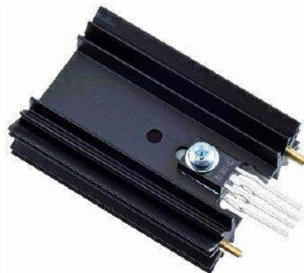
Rysunek 18. Mały radiator z dwoma tranzystorami ustawionymi naprzeciwko siebie. Nie zapomnij o podkładkach
