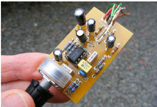
Rysunek 20. Foto zmienionej wersji układu na „starej” PCB; w związku z obecnością dodatkowego sygnału wejścia do regulatora barwy, zabrakło wprowadzeń na przygotowanym złączu MOLEX; należy zwrócić uwagę na przewód biały (z czarnymi kreskami) oraz punkt lutowniczy, który wykorzystano na jego podłączenie (to sygnał INPUT); na podłączenie kondensatora C2 wykorzystano punkty lutownicze nieobecnego stabilizatora bocznikowego
