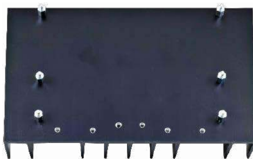
Rysunek 13. Gotowe otwory do montażu tranzystorów mocy
