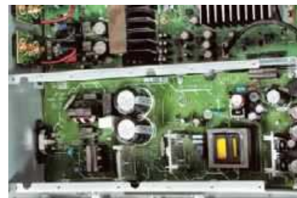
Technics zaprojektował też własny impulsowy tor zasilający z rozbudowaną filtracją napięcia wejściowego i wyjściowego.
