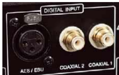
W sekcji cyfrowej pojawiło się coraz rzadziej stosowane, zbalansowane gniazdo standardu AES/EBU.
