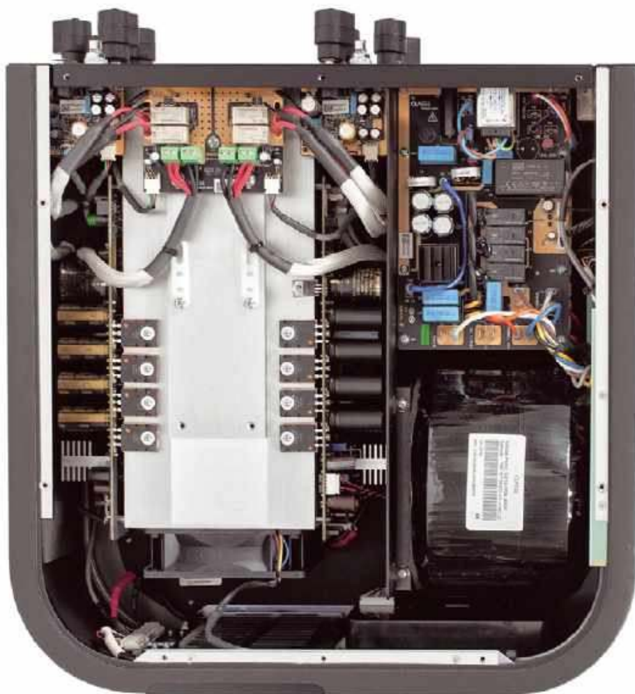
Wnętrze obudowy dzieli pionowy ekran izolujący obwody audio od transformatora zasilającego i elektroniki cyfrowej (głównie sterowanie).
