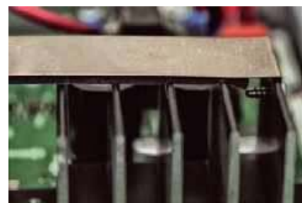
Miło popatrzeć na takie detale: na niewielkie radiatory (końcówek mocy) naklejo paski tłumiące vibracje.
