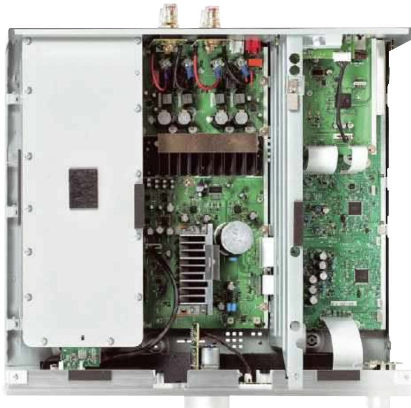
Wnętrze zostało podzielone na trzy czytelne sekcje: zasilającą, końcówek mocy oraz przedwzmacniacza.
