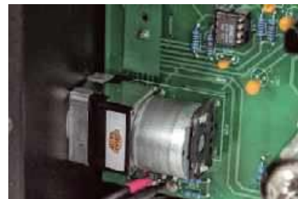
Regulacja wzmacnienia to domena japońskiego Alpsa.
