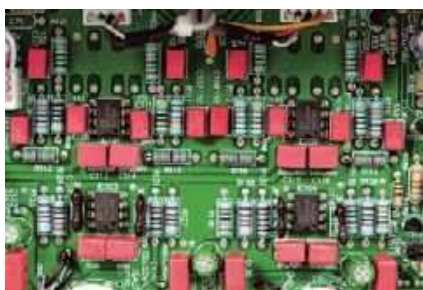
W sekcji półprzewodnikowej – wzmacniacze operacyjne Burr Brown.
