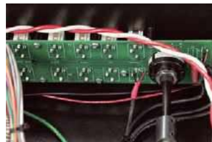
Skróceniu ścieżki sygnałowej sprzyja ułożenie selektora wejść tuż przy gniazdach RCA, ale taka konstrukcja nie pozwala na zdalne sterowanie tą funkcją.
