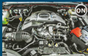
3-litrowy silnik EcoBlue Forda jest niezły. Natomiast 2-litrowy ma pasek rozrządu w kąpiel olejowej.
