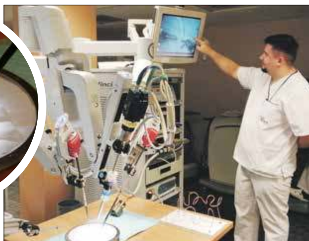
Robot Da Vinci to przyszłość chirurgii. To co wykonują jego ramiona, prowadzone przez operatora, w polu operacyjnym, widać dobrze na monitorze
