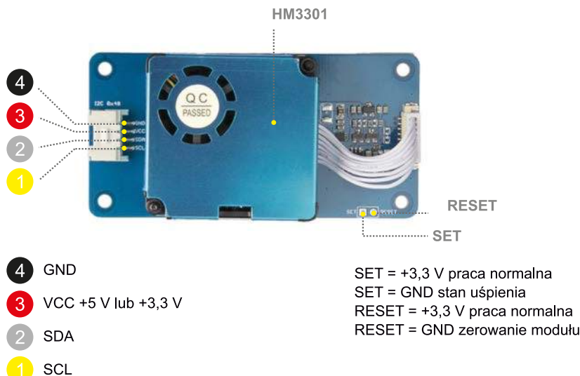
Rysunek 2. Wyprowadzenia modułu HM3301
