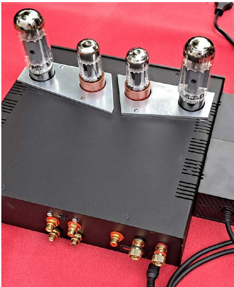
Fotografia 3. Wygląd gotowej konstrukcji z dołączonym zewnętrznym zasilaczem
