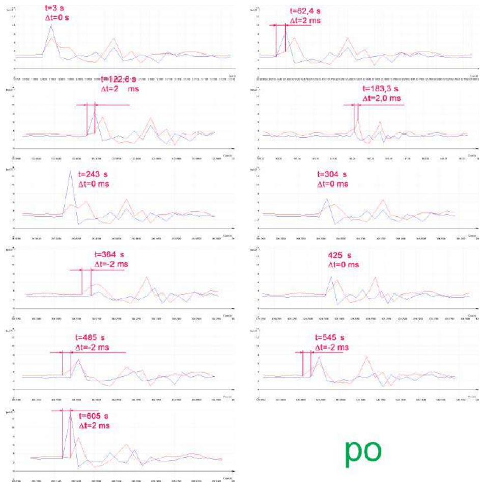
Rysunek 12. Synchroniczne pomiary przebiegów z dobraćnymi rezonatorami
