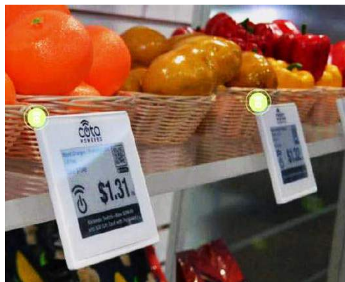
Fotografia 4. Inteligentna metka z technologią ładowania bezprzewodowego Cota [2]
