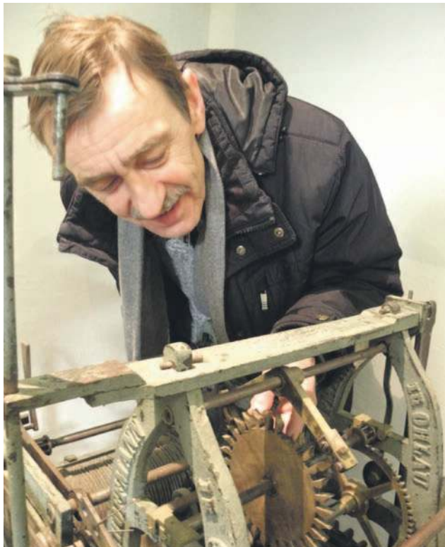
- Wyłamał się mechanizm blokujący bicie - tłumaczy Jan Forczak, miejski zegarmistrz
