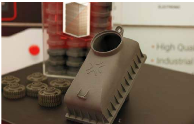
Fotografia 11. Detal drukowany w technologii SLS z użyciem materiału ESD
