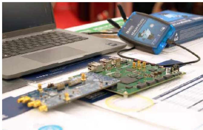
Fotografia 2. Płytki deweloperskie DataStorm DAQ wraz z modułem z radiowym front-endem na bazie ADR9002 (na pierwszym planie) oraz moduł ADALM-PLUTO podłączony do komputera (na drugim planie)
