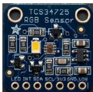
Fotografia 1. Moduł na bazie scalonego czujnika koloru TCS34725, współpracującego z oświetlaczem w postaci białej diody LED SMD ( https://t.ly/zJPtI )
