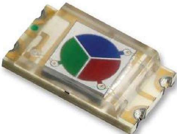
Fotografia 4. Widok czujnika koloru KPS-5130PD7C ( https://t.ly/oxZkt )
