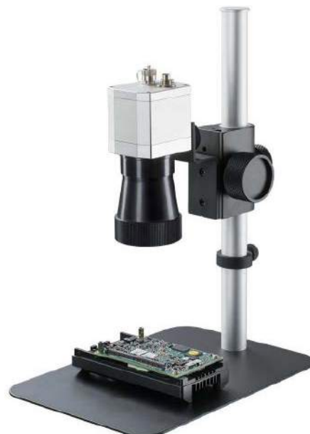
Fotografia 8. Kamera termowizyjna Optris PI640 zamontowana na podstawie mikroskopowej
