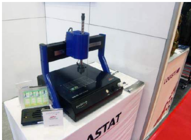
Fotografia 6. Skaner EMC firmy Pendulum na stoisku firmy Astat
