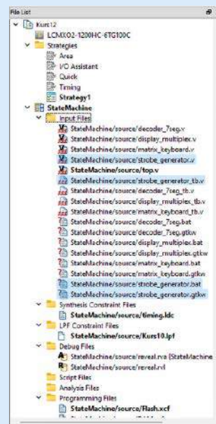
Rysunek 3. Drzewko plików projektowych po dodaniu skryptów symulujących oraz plików konfiguracji przeglądarki GTKWave
