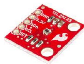
Fotografia 2. Moduł „pasywnego” czujnika koloru, bazujący na układzie ISL29125 – sensor może rejestrować światło padające prosto ze źródła lub odbite od badanej powierzchni, jednak nie zawiera własnego oświetlacza ( https://t.ly/5mLDE )
