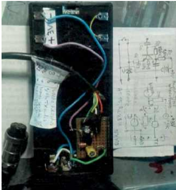
Rys. 3. Schemat przedwzmacniacza do mikrofonu elektretowego
