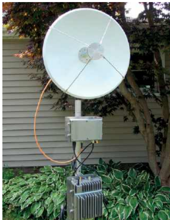
U dołu masztu znajduje się moduł radiowy dla pasm 2 m – 6 cm, a na nim umieszczony jest moduł transwertera na pasmo 10 GHz. Na szczycie masztu znajduje się antena paraboliczna Icom AH-109PB na 10 GHz. Maszt i trójnóg nie należą do kompletu
