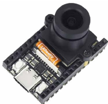
Fotografia 1. Sipeed MaixCAM Lite, tańszy, pozbawiony ekranu wariant MaixCAM
