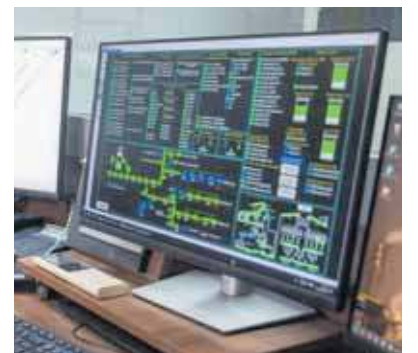
Kopalniane Stacje Geofizyki Górniczej, gdzie dzięki zaawansowanym systemom monitorowania sejsmicznego, wykrywa się i lokalizuje wstrząsy górotworu (fot. Krzysztof Grzybowski/PKW SA)
