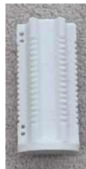
Karkas cewki generatora wydrukowany na drukarce 3D
