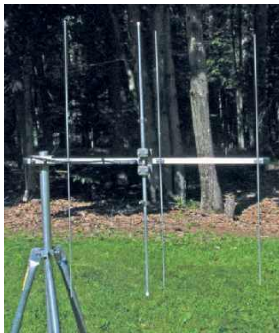
Antena Yagi na pasmo 2 m zamontowana w pozycji pionowej na trójnogu
