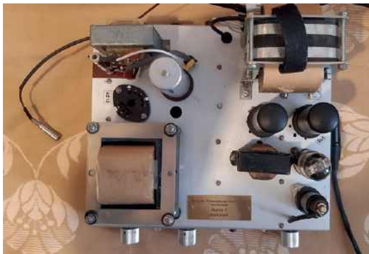
Modulator od strony elementów
