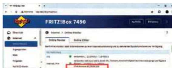
Rys. 3. Odczyt adresu IP modemu dostępowego w jego konfiguracji na przykładzie modelu FRITZ!Box 7490
