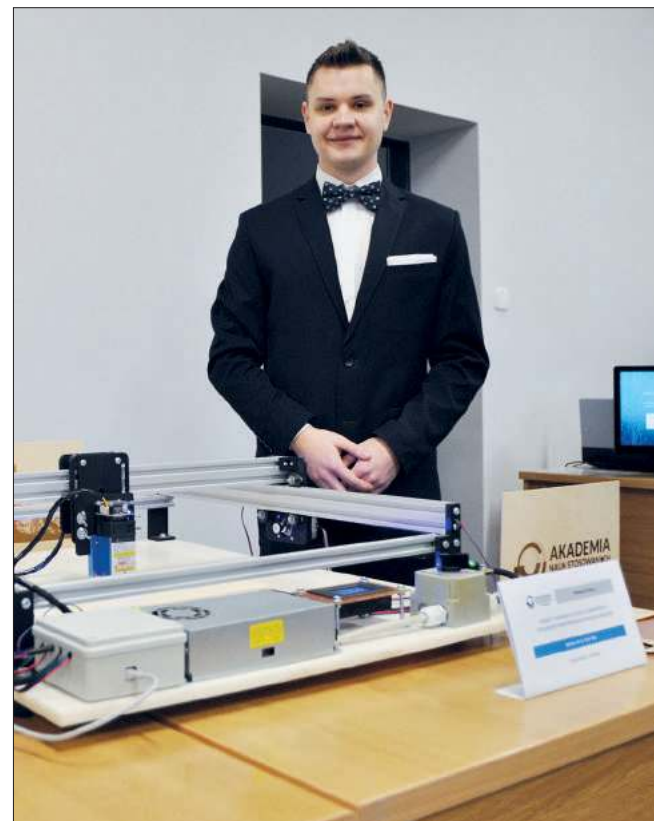
■ Mateusz Drobny zaprojektował i zbudował ploter laserowy z wykorzystaniem mikrokontrolera Arduino
