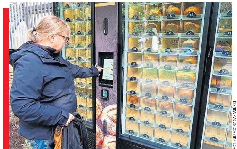
Na ekranie trzeba wybrać rodzaj pieczywa i zapłacić zbliżeniowo kartą. To zwalnia elektryczny zamek danej sekcji i otwiera wybraną szufladkę, z której wyjmujemy się pieczywo.
