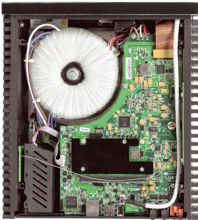
W całej linii Uniti , Naim konsekwentnie stosuje układy liniowe. Dopiął swego nawet w najmniejszym modelu Atom , co wymagało już wyjątkowej gimnastyki.
