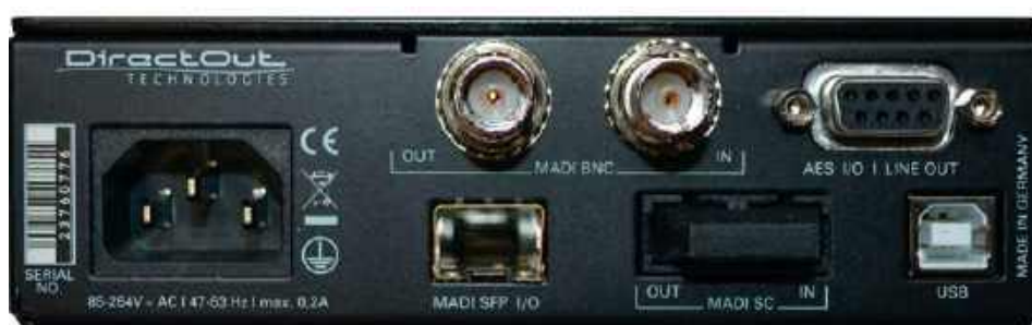
Panel tylny to szereg gniazd – zasilające, MADI BNC, światłowodowe MADI S.C., MADI SFP, złącze DB9, a także USB typu B.
