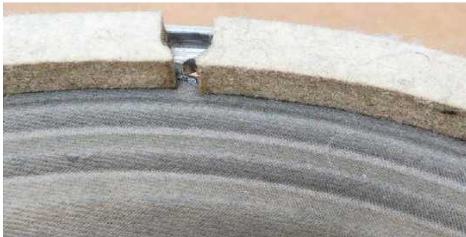
Górne zawieszenie membrany RFT jest tego samego rodzaju, jak w głośniku Goodmansa.
