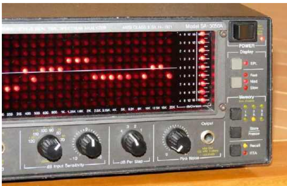
Początek lat 80., dzięki pojawieniu się na rynku analizatorów RTA, przyniósł pewien postęp, zwiększający możliwości operacyjne o analizę odpowiedzi systemu w czasie rzeczywistym.
