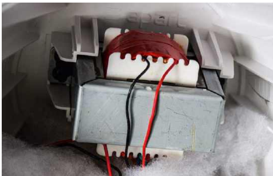
Transformator głośnikowy przymocowany jest wewnątrz obudowy, do górnej ścianki zestawu.
