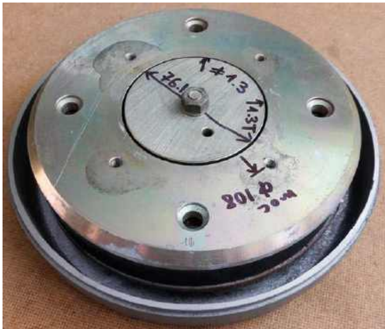
Obwód magnetyczny umieszczono wewnątrz aluminiowej osłony.
