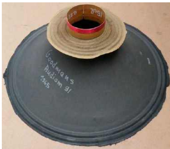
Cewka i pozostałe elementy przetrwały w dobrej kondycji od 1965 roku.
