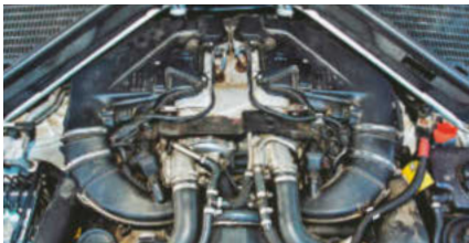
TURBOSPREŻARKI pomiędzy głowicami mają dodatkowe chłodzenie cieczą. Ale i tak generują mordercze dla silnika temperatury.
