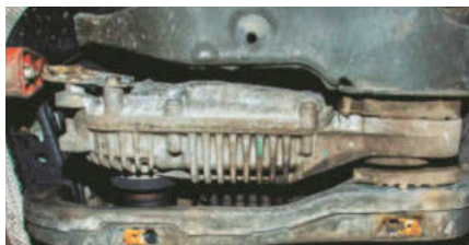
UKŁAD PRZENIESIENIA NAPĘDU jest bardzo wrażliwy na nieprawidłowy rozmiar opon.
