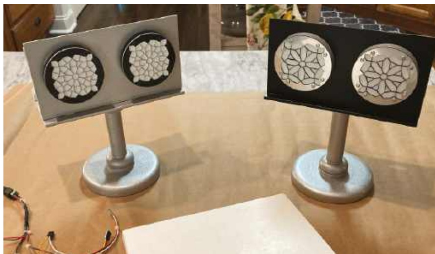
Rysunek 9. Dwie głowice robota z 45-segmentowymi powłokami (po lewej) i 29-segmentowymi powłokami (po prawej)
