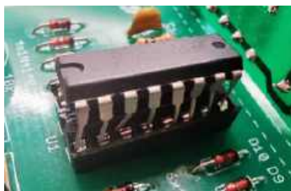
Fotografia 28. Przed wciśnięciem układu scalonego w podstawkę, należy upewnić się, że wszystkie wyprowadzenia układu scalonego trafiły w odpowiednie gniazda, a następnie wzrokowo kontrolować cały proces docisku. W przeciwnym wypadku nóżki układu scalonego mogą zacząć się giąć, a nawet złamać
