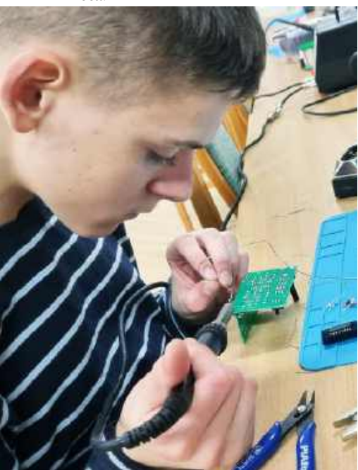
Fotografia 21. Kornel łączy wcześniej zmontowane płytki (sterującą i wykonawczą) stroboskopy dyskotekowego LED w jedną całość. Młodzi Entuzjaści Elektroniki, Szkoła Podstawowa nr 86, Wrocław
