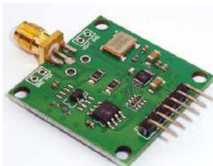
Rysunek 6.10. Moduł AD9833 o poprawionych parametrach (działa przy wyższych częstotliwościach)
