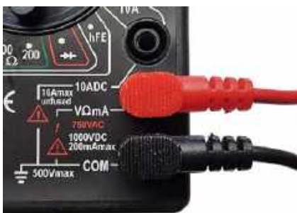
Fotografia 26. Poprawne podłączenie kabli na przykładzie multimetru DT-830B ustawionego na funkcję woltomierza napięć stałych
