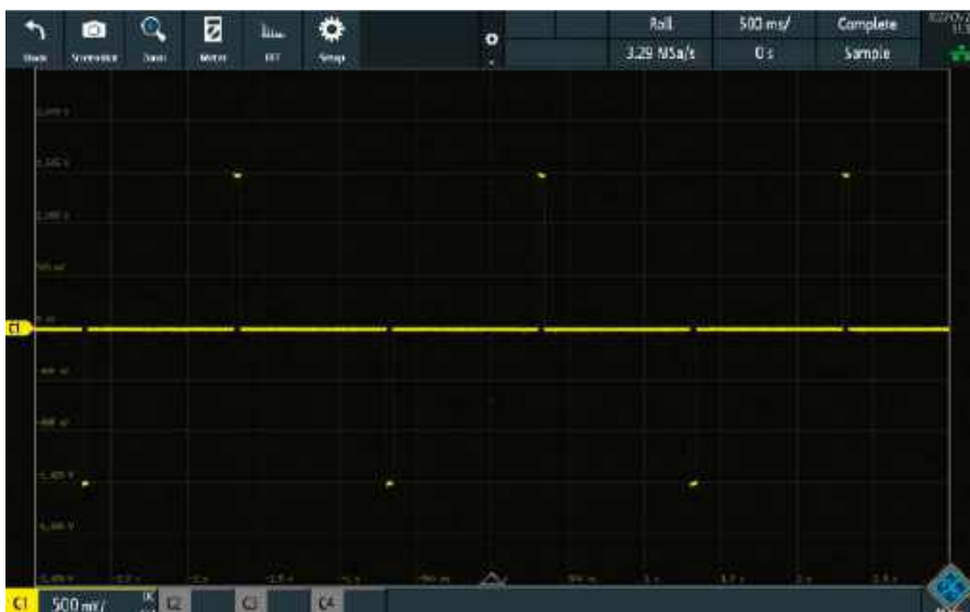
Oscylogram 1. Wyjście sterownika zegara dla ruchu krokowego składa się z naprzemiennie dodatnich i ujemnych impulsów, które sprawiają, że wirnik silnika zegara wykonuje krok o 180^\circ z każdym impulsem. Impuls taki trwa około 40 ms i jest wytwarzany raz na sekundę
