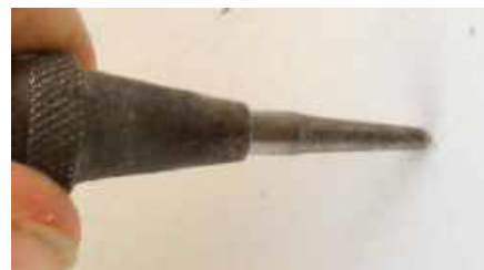
Rysunek 15. Punktak automatyczny. W przypadku wiercenia dużej ilości otworów ta inwestycja bardzo się opłaca
