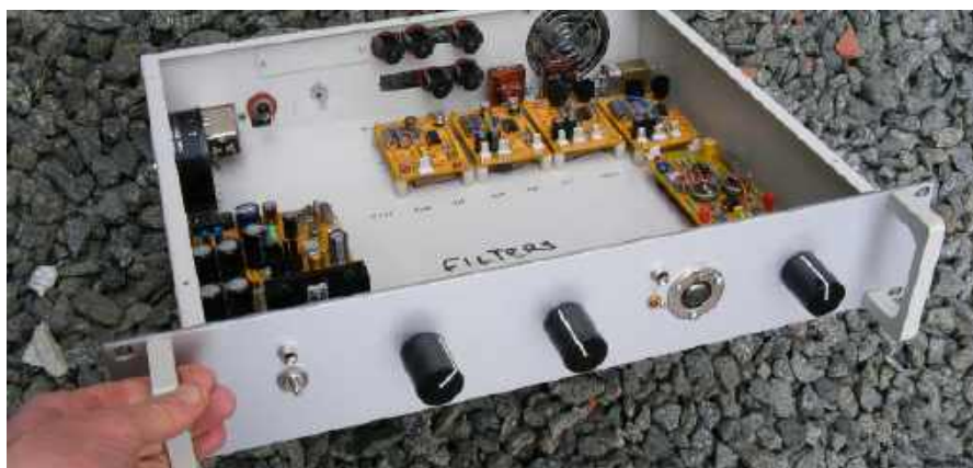
Rysunek 9. 19-calowa obudowa „rackowa”. Nowa jest droga, ale można taką kupić okazji
