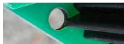
Rysunek 5 (po lewej). Żeby odstąpić otwór montażowy, trzeba spiliwać część żebra radiatora dla IC2. Można też użyć śruby plastikowej lub wywiercić drugi otwór obok
