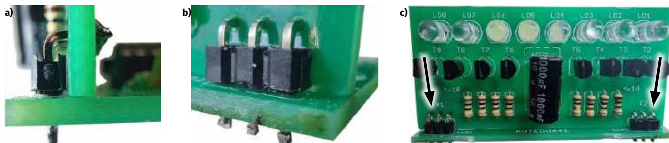
Fotografia 20a, b i c. Sposób łączenia płytki sterownika i wykonawczej za pomocą dwóch kątowych, pojedynczych, trzypinowych złączy goldpin o rastrze 2,54 mm.
