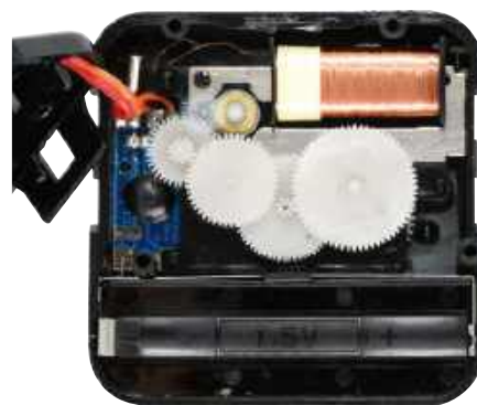
Wnętrze typowego mechanizmu zegara ściennego zmodyfikowanego dla naszego sterownika zegara. Cewka silnika znajduje się w prawym górnym rogu, natomiast niebieska płytka sterująca znajduje się po lewej stronie, z kropką czarnej żywicy epoksydowej ukrywającej układ sterujący. Został on wyłączony poprzez wycięcie ścieżki PCB, a przewody zostały przylutowane do punktów lutowniczych cewki silnika
