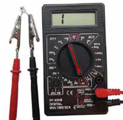
Fotografia 13. Sprawdzanie diody LED za pomocą multimetru ustawionego na testowanie diod. Po przyłożeniu sondy czerwonej do anody, a czarnej do katody sprawna dioda LED powinna się zaświecić. Jeśli dioda ma odpowiednie długie (jeszcze nie przycięte) wyprowadzenia można się wspomóc krokodylkami
