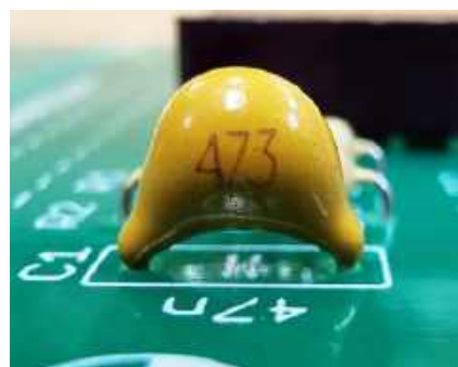
Fotografia 9. Montaż kondensatora statego C1. Kierunek montażu jest obojętny. Na obudowie kondensatora widać napis „473” informujący o pojemności 47 i 3 zera pikofarów (47000 pF) czyli 47 nF
