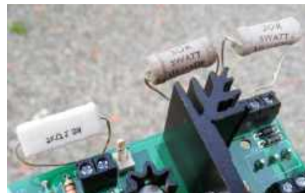
Rysunek 3. Końcowy test zasilacza – obciążenie linii wyjściowych rezystorami drutowymi dużej mocy. Zawsze w ten sposób „wyrzuję” zasilacz zanim użyjesz go do normalnego działania. Zawsze wykryjesz uszkodzone elementy lub złe zamocowanie radiatora
