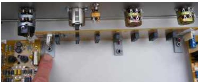
Rysunek 19. Montaż płyty głównej na kątownikach
