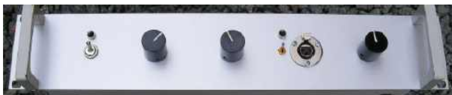
Rysunek 11. Panel przedni. Pokrętła od lewej do prawej: poziom sygnału bezpośredniego nośnej (syntezatora), poziom sygnału bezpośredniego modulatora (mikrofonu), wzmacnienie mikrofonu
