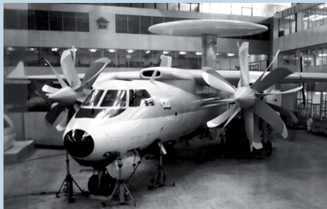
▲ Pełnowymiarowa makieta radzieckiego pokładowego samolotu dozoru radiolokacyjnego Jak-44.
