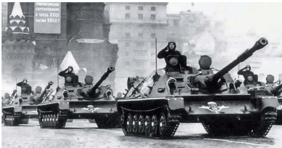
▲ Podstawowe uzbrojenie ASU-85 oparte było o gwintowaną armatę D-70 kal. 85 mm. Działa, zwane przez załogi „krokodylami” podczas defilady na Placu Czerwonym.
