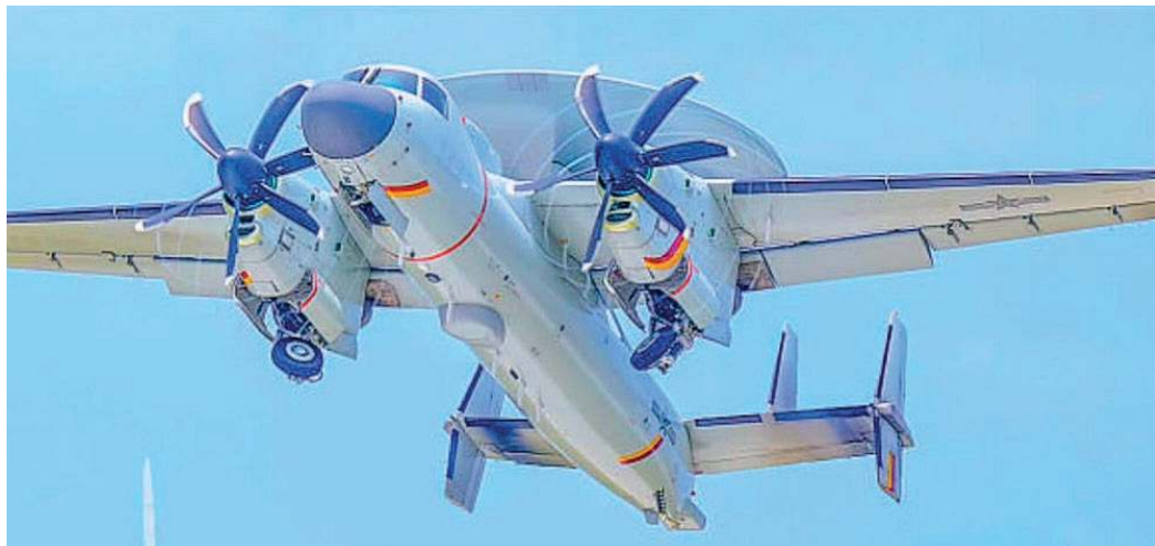
▲ Zmodernizowany KJ-600 i dobrze widoczna podkadłubowa osłona anteny transmisji danych. Miecowych anten pod kadłubem nie ubyło, nie zmieniło się też ich rozmieszczenie, co może wskazywać na przewidywaną od początku instalację dodatkowej osłony dielektrycznej pod kadłubem.
