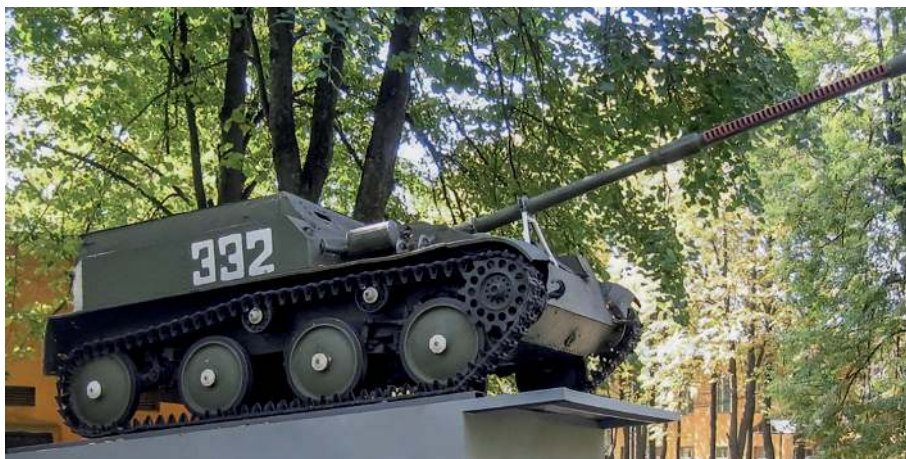
▲ ASU-57 w formie pomnika, ale dobrze widoczny układ konstrukcyjny armaty Cz-51 z charakterystycznymi wycięciami pełniącymi rolę hamulca wylotowego.
