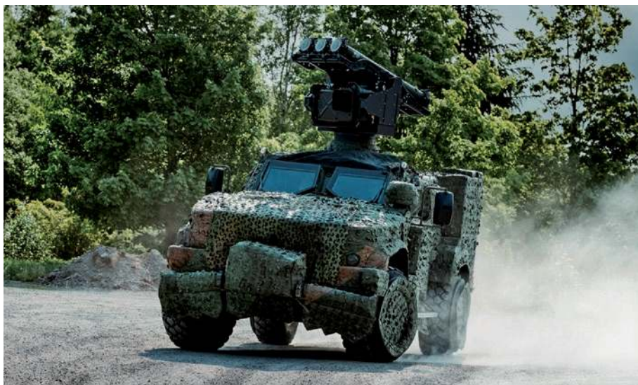
▲ Opancerzony pojazd terenowy Oshkosh JLTV z zintegrowaną wyrzutnią RBS 70 NG to tylko jedna z propozycji w zakresie MSHORAD (Mobile Short Range Air Defence).
