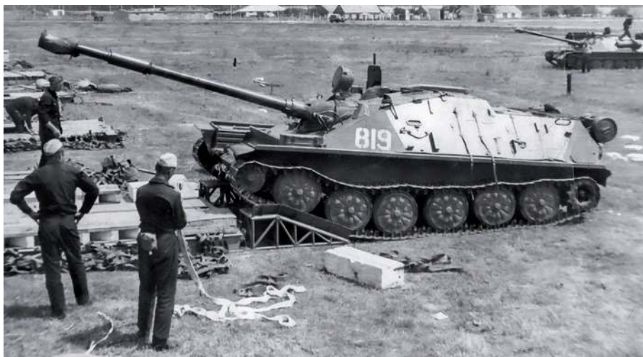
▲ ASU-85 podczas wjazdu na platformę desantową, po czym następowało kilkugodzinne przygotowanie działa do zrzutu spadochronowego.
