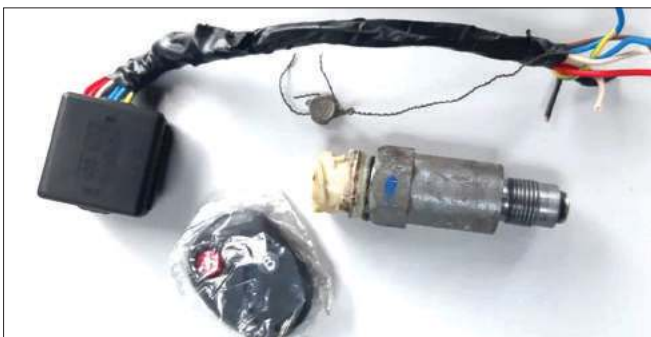
Elementy zmanipulowanego tachografu
