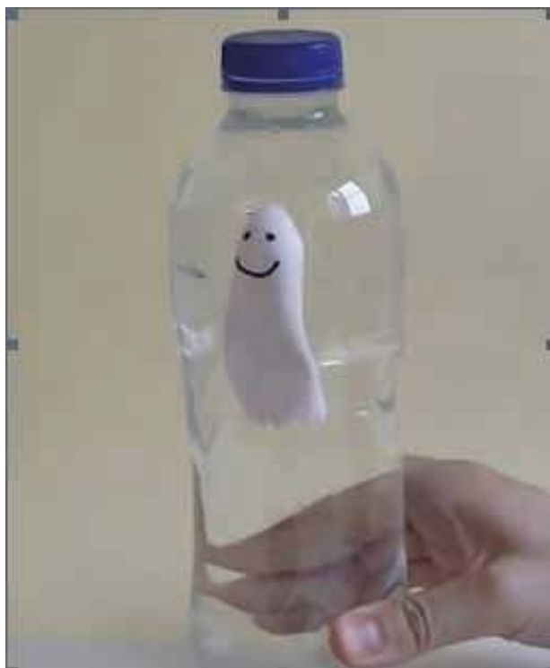
Foto. 2. „Duszek” zanurzający się i wypływający w zależności od ciśnienia wywieranego na butelkę. Ekspresje pokazu zwiększa zastosowana przez autorów muzyka. Fragment Tokaty Jana Sebastiana Bacha. https://www.youtube.com/watch?v=Y5JwNPtAqOM
