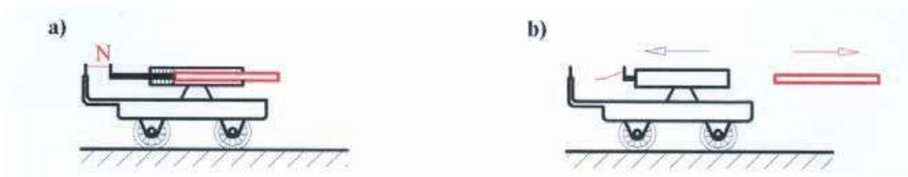
Rys. 4. Eksperyment ilustrujący prawo zachowania pędu. a) wózek przed wystrzałem, b) wózek po wystrale. Źródło: J. Liwo, B. Porala, Materiały pomocnicze z fizyki. Materiały wewnętrzne WFTiMS PG
