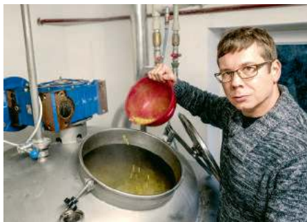
Kiedy temperatura brzezki zbliża się do 100 st. C, Michał Kojro dodaje do kotła zielony granulat chmielowy.
