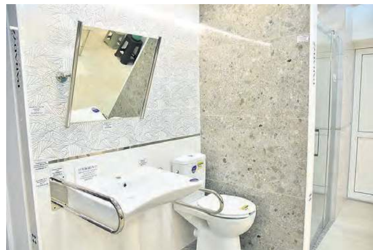
Łazienka przystosowana do potrzeb osoby niepełnosprawnej. Jest tu np. specjalny kompakt, nieco wyższy niż standardowy. Umywalka została wyprofilowana, jest możliwość swobodnego podjechania wózkiem inwalidzkim.
