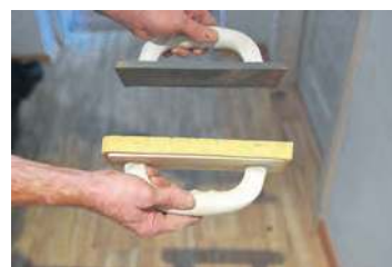
Packi potrzebne przy nakładaniu fug.
