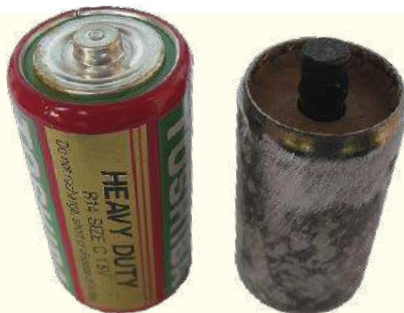
7. Twoje źródło cynku: ogniwo R14 (z lewej po zdjęciu osłony widoczny jest cynkowy kubek)
