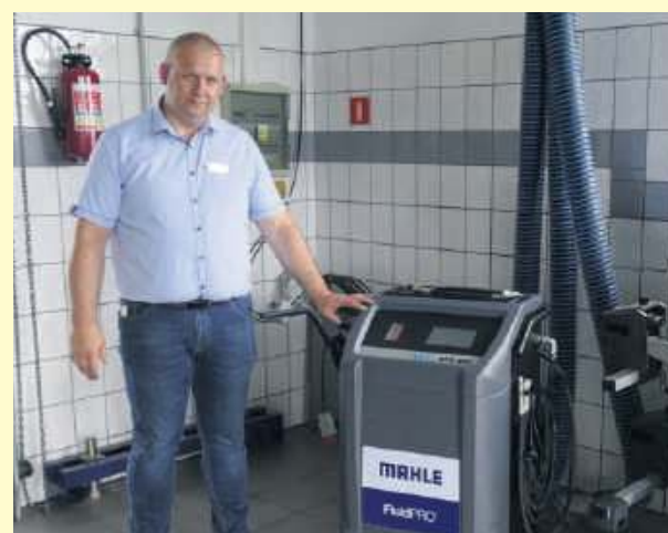
- Firma Statkiewicz Bosch Auto Service wykorzystuje do dynamicznej wymiany oleju w automatycznych skrzyniach biegów stację Mahle FluidPRO ATX 180 – wyjaśnia kierownik serwisu samochodowego Jarosław Niedźwiecki
