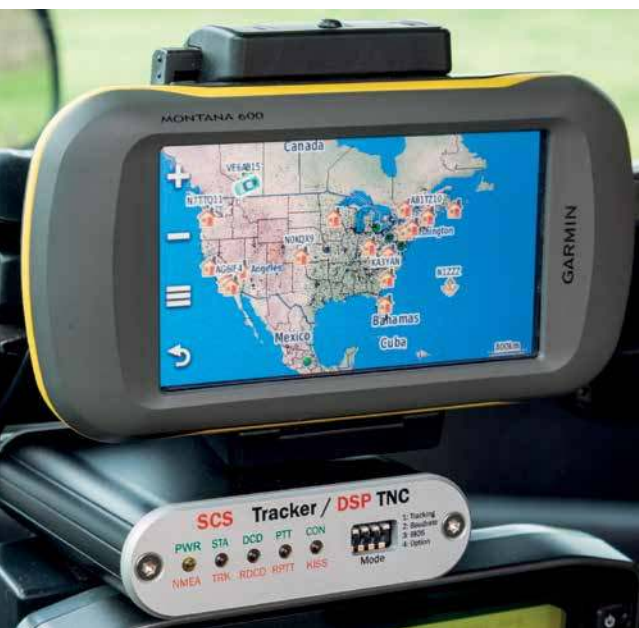
Modem SCS Tracker firmy SCS wraz z odbiornikiem GPS na wyposażeniu stacji stałej
