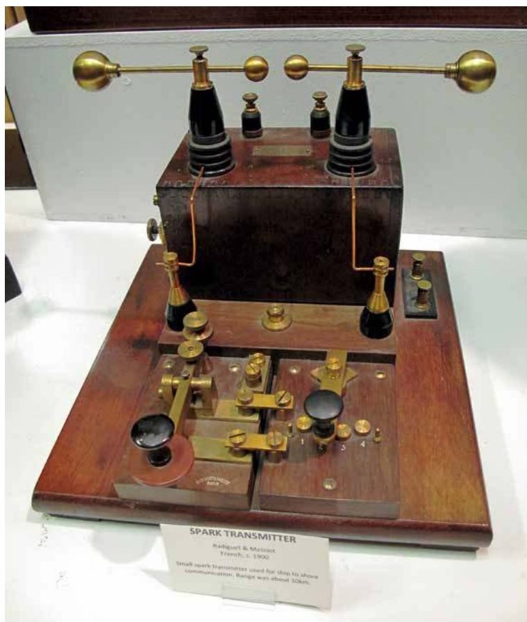
Francuski nadajnik iskrowy Radigue & Massiot z roku 1900
