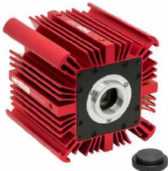
Fotografia 10. Przykładowa kamera sCMOS marki Thorlabs ( http://t.ly/Fy2ba )
