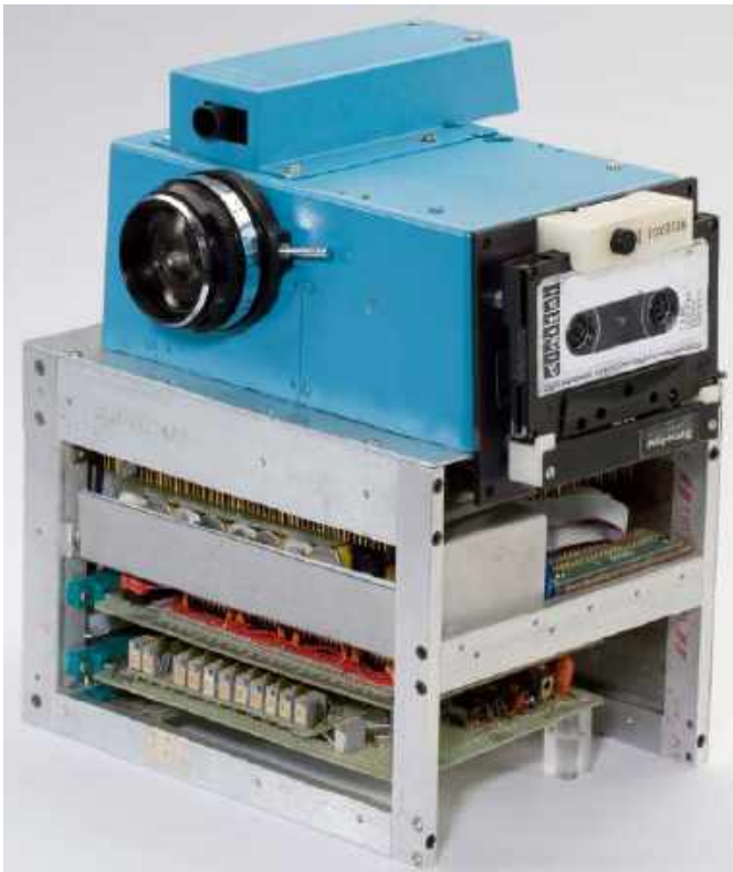
Fotografia 3. Pierwszy na świecie aparat cyfrowy konstrukcji Steve'a Sassona ( http://t.ly/b7vIQ )
