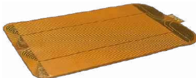
Fotografia 2. Dwuwarstwowy obwód drukowany na podłożu elastycznym
