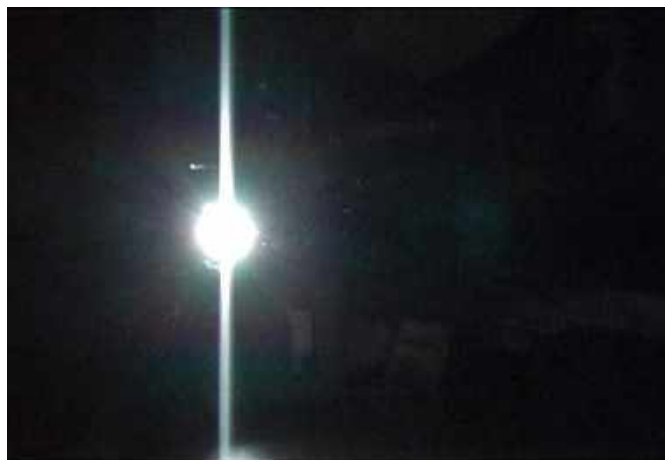
Fotografia 5. Ilustracja artefaktu określonego jako smearing , występującego w matrycach CCD FT ( http://t.ly/oyzPe )
