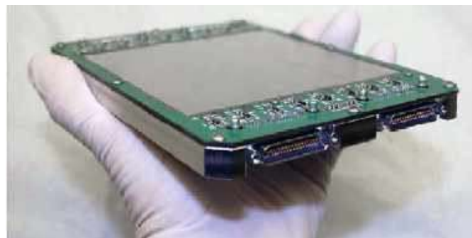
Fotografia 11. Duża, 100-megapikselowa matryca CCD marki Andanta do specjalistycznych zastosowań naukowych ( http://t.ly/joBNW )
