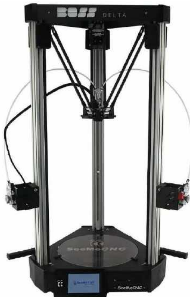
Fotografia 7. Drukarka typu Delta – głowica znajduje się na trzech sztywnych ramionach, których wysokość kontrolują trzy silniki krokowe
