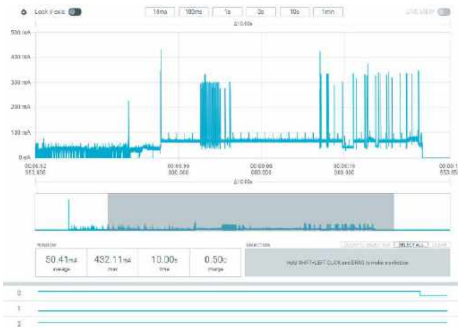
Rysunek 3. Pobór prądu płytki Enviro Weather podczas bloku pomiaru i transmisji danych
