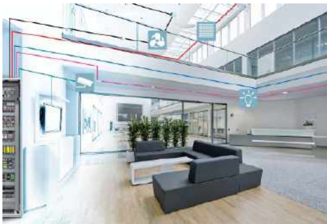
Fotografia 2. Automatyzacja budynkowa: SPE idealnie nadaje się do łączenia i przekazywania danych generowanych przez wiele instalacji budynkowych
