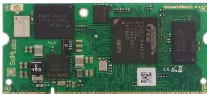
Fotografia 6. Moduł SoM firmy SomLabs wyposażony w pamięć RAM 1 GB typu DDR4, pamięć eMMC o pojemności 32 GB oraz pamięć Flash QSPI (http://t.ly/CVdwb)
