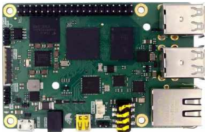
Fotografia 5. Komputer jednopłytkowy typu TitanSBC wyposażony w procesor i.MX8 współpracujący z 4 GB pamięci LPDDR4 (http://t.ly/kYJaQ)
