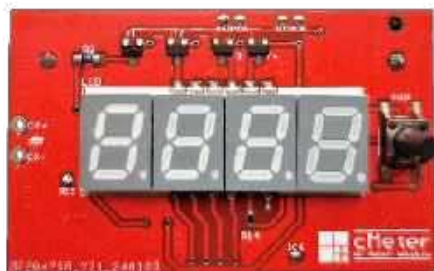
Fotografia 1. Zmontowane urządzenie cMeter od strony warstwy TOP
