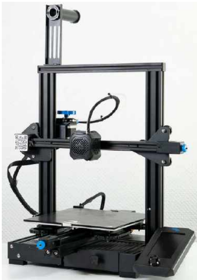
Fotografia 4. Drukarka 3D typu „bed slinger”
