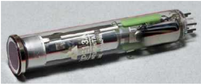
Fotografia 2. 17-milimetrowa lampa analizująca typu Vidicon ( http://t.ly/JAYOW )
