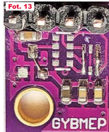
Fotografia 13 przedstawia posiadany moduł BME280 po takim zabiegu.
