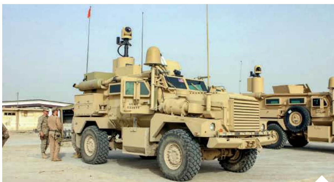
MRAP Cougar 4x4 umożliwia osiągnięcie prędkości 105 km/h i ma zasięg wynoszący aż 966 km | fot. Wikipedia/d
